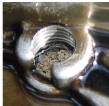
締めすぎてネジ部が欠落したオイルパン
