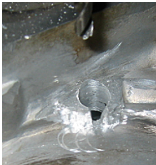
オイルの逃げをヤスリで作って タップでネジを切ります 最後に綺麗に磨きをかけて完成です 無くなったネジ部の復活です
