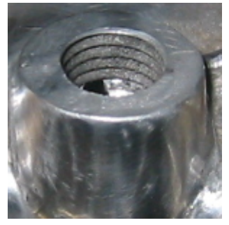
オイルの逃げをヤスリで作って タップでネジを切ります 最後に綺麗に磨きをかけて完成です 無くなったネジ部の復活です
